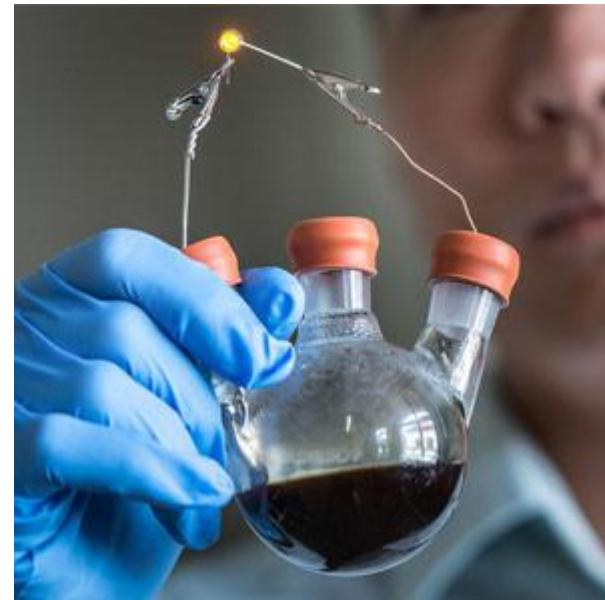
Solucion de polisulfuro, anodo de Li y catodo de S/C
